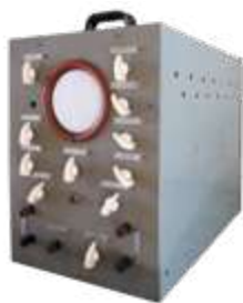
Oscilloscope permettant de mesurer et d'afficher la tension en fonction du temps, fabrication Pagnier — 1958
