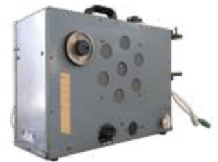
Mesureur de champs Pagnier permettant d'effectuer des mesures de puissance et de qualité du signal de réception télévision — 1952
